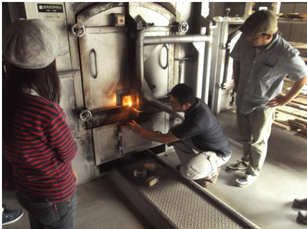
図3 弱還元焼成時の炉内観察
