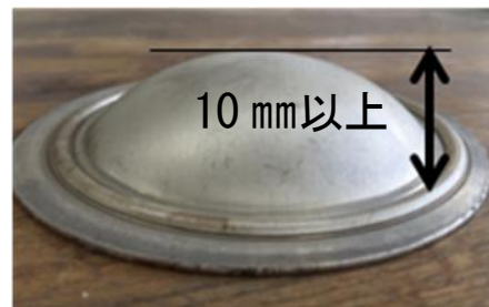
図 7 温間ブロー成形 (マグネシウム合金: AZ31)
