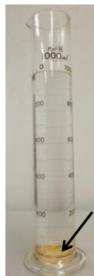
図 4 コバルトめっき液の均一液抽出(1000 ml) (矢印部の析出相にコバルトが濃縮されている)
