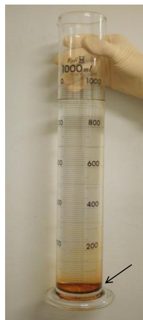
図 7 パラジウムめっき液の均一液液抽出(1000 ml) (矢印部の析出相にパラジウムが濃縮されている)
