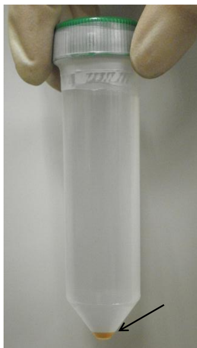
図 2 コバルトめっき液の均一液抽出 (矢印部の析出相にコバルトが濃縮されている)
