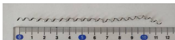
図12 強アルカリイオン水で加工した時の切屑
