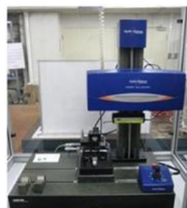
図6 表面粗さ輪郭形状測定機 (アメテック製フォームタリサーフ PGI 1240)
