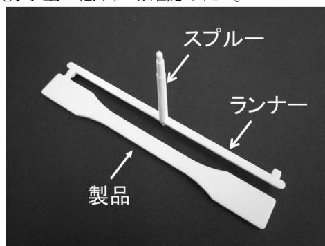
図1 射出成形機で作成した製品 （ダンベル型試験片）
