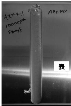
接合部裏面にはマクロ的な接合欠陥は観察されず, 平滑な接合面であるが, 熱影響による材料表面の変色が観察された。
