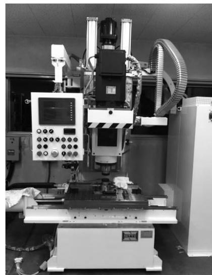
図 3 摩擦攪拌接合装置
