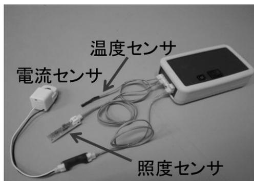
図 5 開発したセンサモジュールの外観
