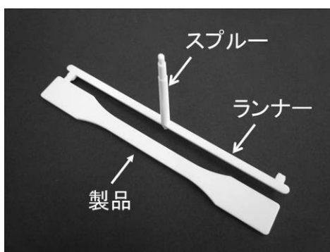
図1 射出成形機で作成した製品 (ダンベル型試験片)
