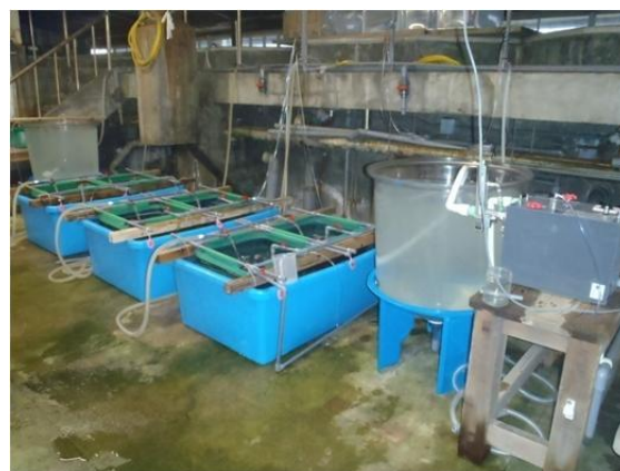
図 7 アワビの稚貝用育成施設(左)とバブル発生装置(右)
