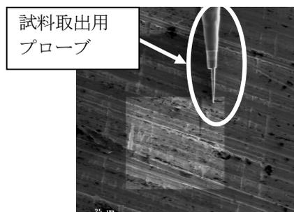
図 3 試料取出用プローブ
