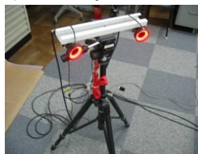
図 5 ステレオカメラ 図 6 テストチャート画像
