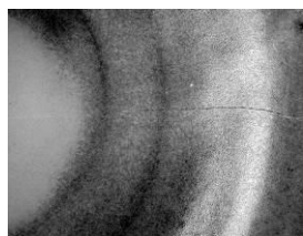
図1 シバリングにより割れた試験体
