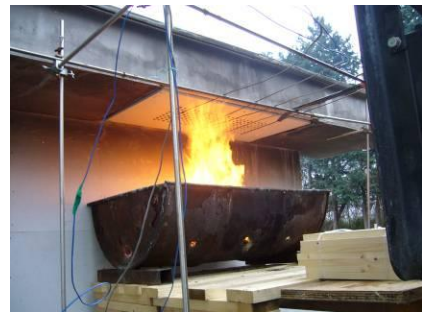
図 9 軒天井板の火炎暴露試験の状況
