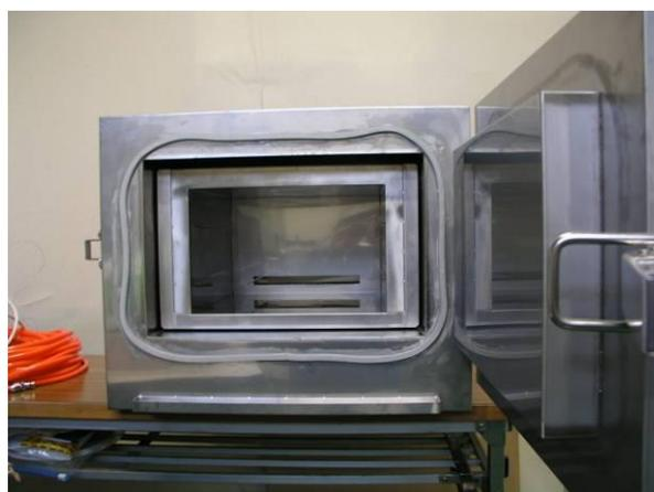
試験用小型過熱蒸気殺菌装置写真
