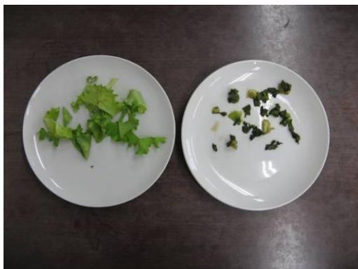
カットレタスの過熱蒸気処理結果写真
