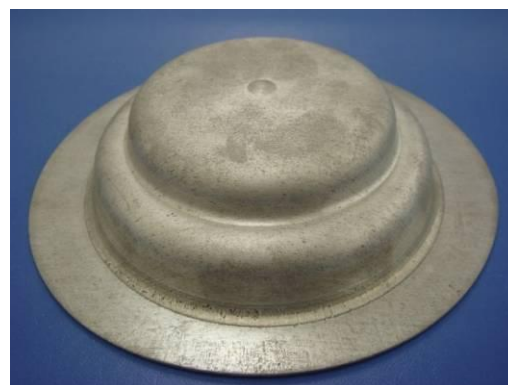
図7 段付きブロー成形品（成形時間：30s）
