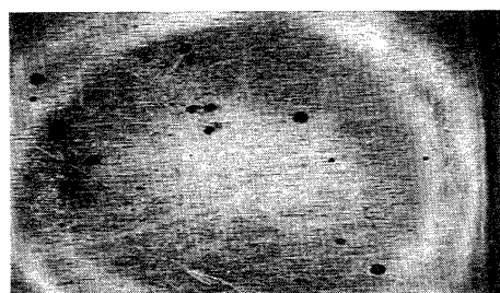
図11 試料B C7250 ワックスコート 500時間経過
