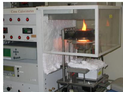
図2 コーンカロリメータ燃焼試験
