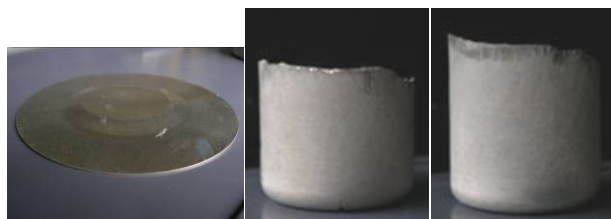
図 6 AZ61 合金の深絞りとカップの外観 (左：373K 中央：473K 右：573K)
