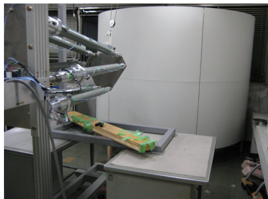
Fig. 14 マニピュレータと直径が実物大の反応塔の模型
