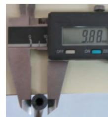
図1 押し出し成形による熱膨張性難燃チューブの作製 図2 作製チューブ(外径9.88mm)
