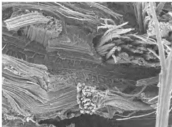
図6 PP/竹繊維20%複合材料断面の電子顕微鏡写真
