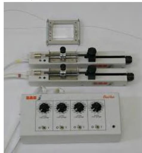
図3 マイクロガラスチップとシリンジポンプ
