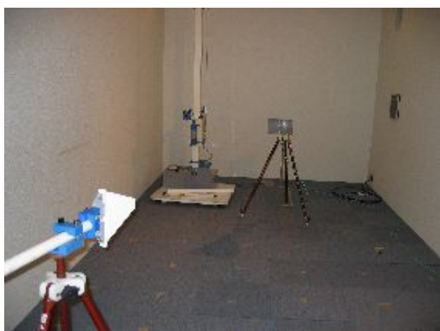
図 2：1[GHz]～18[GHz]での NSA 測定
