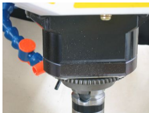
図9 主軸への切り屑の付着
