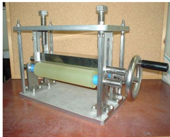
図5 連続ひずみ付加装置 (試作)
