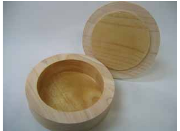
図8 木容器内面へのフィブロインコーティング
