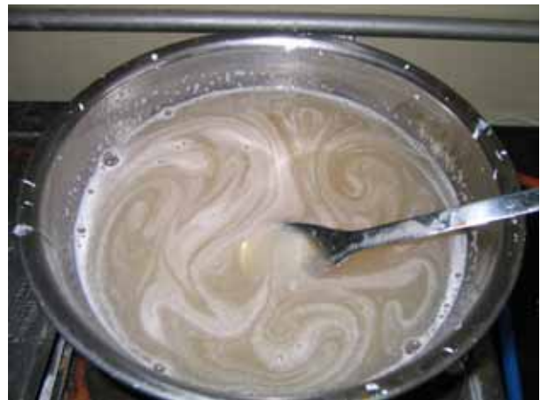
図3 絹糸が完全に溶解した状態
