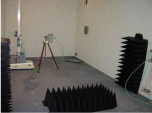
図7：電磁波吸収体 床・壁面設置
