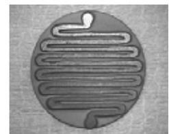
図-4 サンドブラストにて成形したニッケル-セリサイト複合材料発熱体
