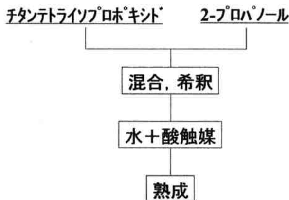
図1. 酸化チタンゾル溶液の作製フロー
