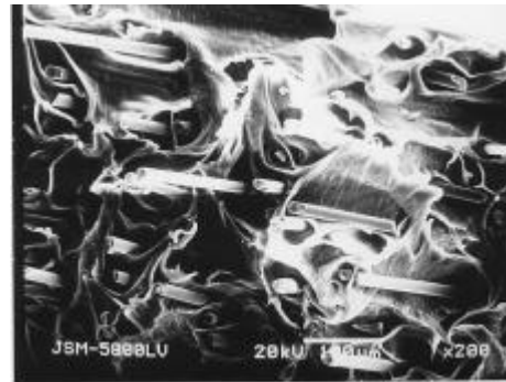
(d) LLDPE100/GF5(処理)
