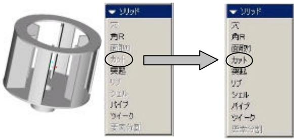
図6 ソリッドとして認識されない不具合とソリッドとして認識され使用可能となったコマンド
