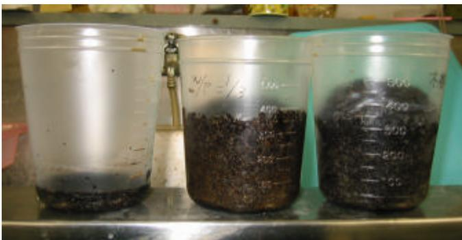
写真7 試作した発泡体(植木剪定枝粉末液化物)
