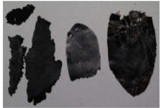
写真4 ミキサー混練による液化木材・PEG(200万)シート
