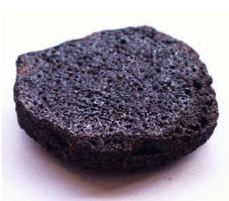
写真5 液化木材による発泡樹脂(発泡剤なし)
