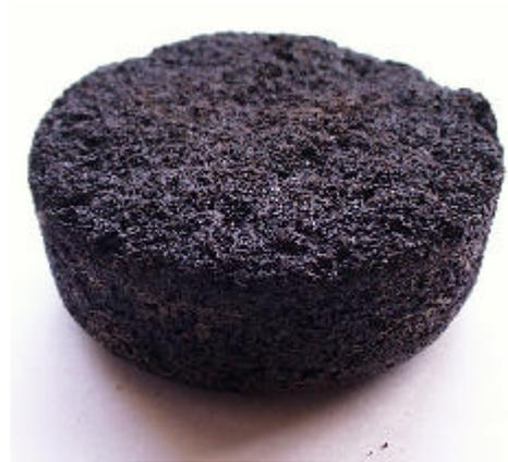
写真6 液化木材による発泡樹脂(発泡剤:重曹3g)
