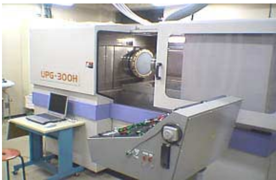
図4 地域コンソーシアム研究開発事業で開発したシリコンウエハ用超精密研削加工機械
