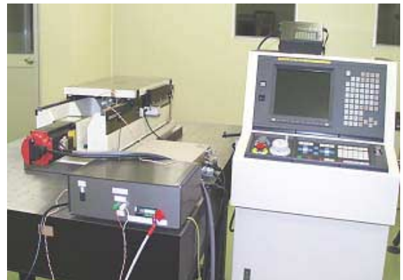
図3 精密機器用高性能位置決めテーブルの外観
