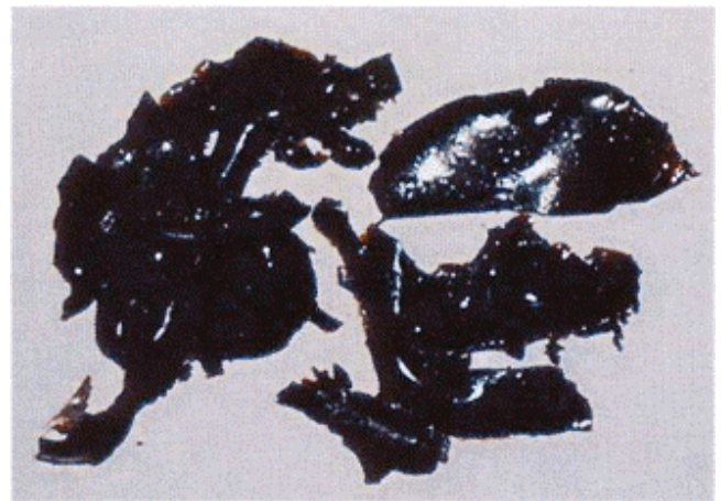
写真2 液化木材とエポキシ樹脂の混合樹脂
