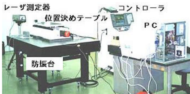
図8 開発した高性能位置決めテーブルの全体図
