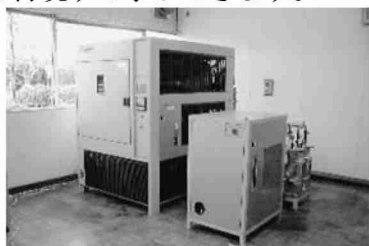
低温サイクル 7.5kWキセノンウェザーメーター X L75 スガ試験器株式会社製
