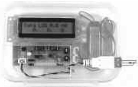
図1 試作した測定結果表示装置
