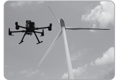
ドローンによる風力発電設備の検査 (イメージ)
