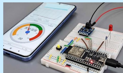
小型マイコンとスマートフォン による熱情報の可視化
