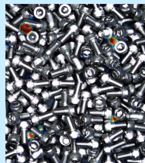
M6ボルトに混入した M8ボルトの検出結果
