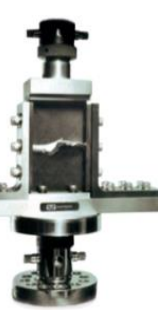
コンポジット試験治具 (航空機関連規格に対応したCFRP用試験治具)
