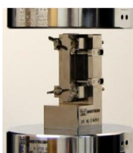
コンポジット試験治具 (航空機関連規格に対応したCFRP用試験治具)
